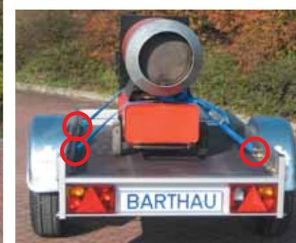
**Typ QM als Maschinen- und Geräte-fahrgestell;** in allen gängigen Gesamtgewichten sowie Längen und Breiten lieferbar. Auch der Typ QM hat die Ladungssicherung **TOPZURR24** und ist als Tieflader in Vollaluminiumausführung, wie der QL, leicht im Gewicht und witterungsbeständig.
