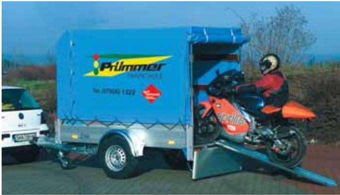
**Fahrschulanhänger QL 1801** mit Zubehör Dachgestell und Plane sowie Motorradtransportsatz. Der Planenaufbau ist für Prüfungsanhänger vorgeschrieben.
