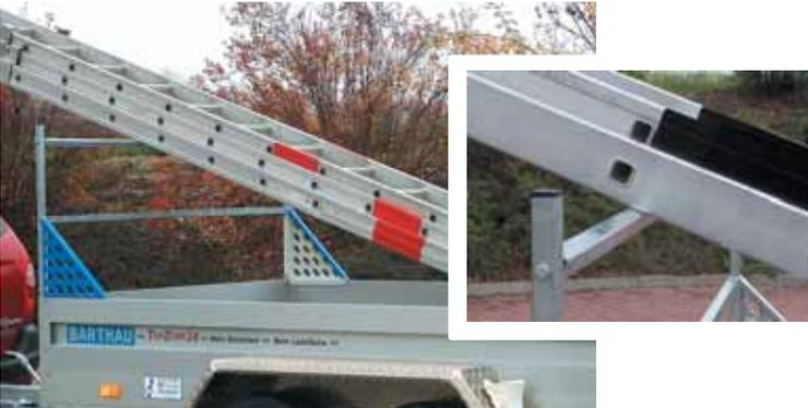
**H-Galerie 600mm hoch** gesichert mit stabilen Lochblechen gegen unbeabsichtigtes Herausziehen oder Kippen. Das obere Vierkanrohr ist drehbar gelagert und paßt sich dem Ladewinkel automatisch an. Beschädigungen an Aluminiumleitern werden vermieden.
