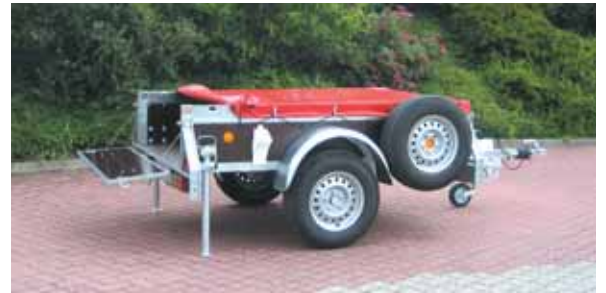
PK 1001 mit vorderer Klappe serienmäßig und Vierkant-Rohrbremse sowie Stützrad leicht. Zusätzlich mit Zubehör: Rohrstützen mit doppelter Klemmhalterung, Ersatzrad mit Halterung und PVC-Plane flach gespannt in Sonderfarbe RAL3000 feuerwehrrrot. Die Heckklappe gerade gestellt ist serienmäßig.
