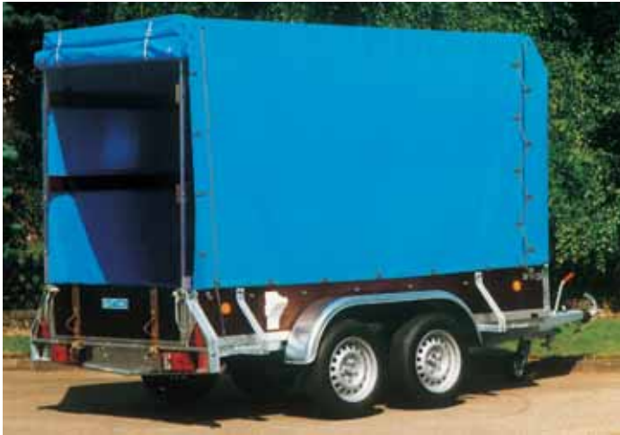
PK 2002 mit Zubehör Dachgestell und PVC-Plane 1600 mm. Dies entspricht einer Ladehöhe von 2000 mm. Diese Plane ist in der Sonderfarbe RAL 5015 himmelblau .
