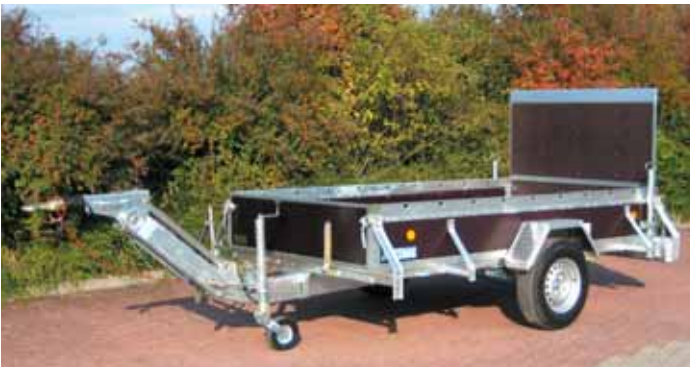
Typ PK mit höhenverstellbarer Auflaufbremse mit DIN-Zugöse für LKW. Verstellbar von 400 mm bis 1100 mm Anhänghöhe. Vordere Klappe nur abnehmbar nicht umklappbar. Zu Kugelpupplung wechselbar gegen Mehrpreis. Ausserdem Zubehör: Alu-Riffelblech-Kotflügel, Laderampe.
