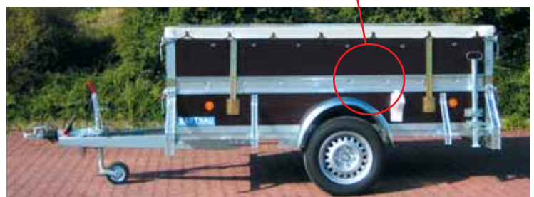
PK 1351 serienmäßig mit Zugholmen und V-Bremse, sowie Stützrad leicht mit Klemmhalterung geschützt innerhalb der Zugholme montiert. Mit Zubehör: Aufsatz 400 mm, vordere Klappe, 2 Stück Rohrstützen hinten mit doppelter Klemmhalterung und Flachplane in Standardfarbe hellgrau.
