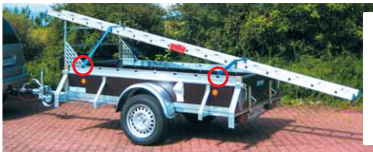
PK 1351 mit serienmäßiger Gurtleiste. Als Zubehör vordere Klappe, H-Galerie, Rohrdeichsel statt Zugholme und V-Bremse, dadurch eine Verlängerung der freien Deichsellänge auf 1525 mm möglich. Deichselverlängerungen sind nur mit Rohrbremse möglich. Sie müssen individuell angefragt werden. Die H-Galerie gibt die Möglichkeit lange, sperrige und große Transportgüter zusätzlich zusammen mit der Gurtleiste noch besser zu befestigen.
