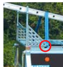
PK 1351 mit serienmäßiger Gurtleiste. Als Zubehör vordere Klappe, H-Galerie, Rohrdeichsel statt Zugholme und V-Bremse, dadurch eine Verlängerung der freien Deichsellänge auf 1525 mm möglich. Deichselverlängerungen sind nur mit Rohrbremse möglich. Sie müssen individuell angefragt werden. Die H-Galerie gibt die Möglichkeit lange, sperrige und große Transportgüter zusätzlich zusammen mit der Gurtleiste noch besser zu befestigen.
