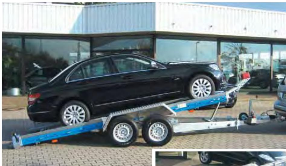
Der flache Auffahrwinkel ist auch für Fahrzeuge mit Spoiler geeignet. Kompakte vollkommen geschützte Beleuchtung. Die Umrißleuchte mit Gummihals ist sehr gut von vorne und hinten zu erkennen.
