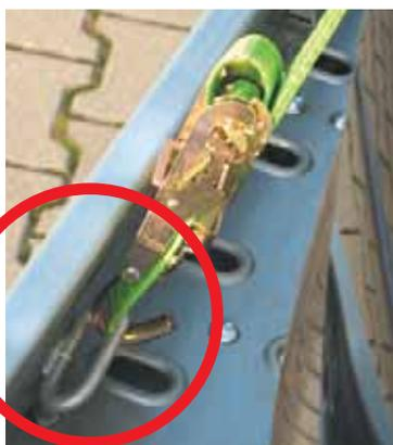
Unser Typ AS hat an beiden Fahrzeuglängsseiten im Rahmen Öffnungen für Zurrösen. Die Zurrösen werden von innen durch das Profil gesteckt und von außen mit einem Bolzen mit Federsicherung arretiert. Sie sind beweglich gelagert.
