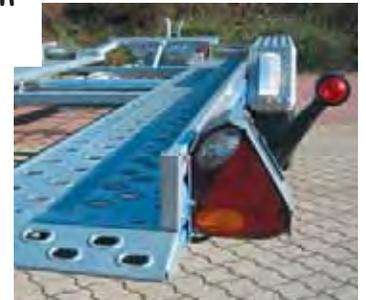
**Beleuchtung geschützt** seitlich montiert. **Flachere Auffahrkante**. **Griffige Stanzlöcher**, besonders rutschfest! **Begrenzungsleuchten** mit **flexiblem Anbauarm** (Gummiarm).
