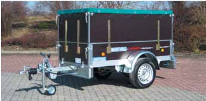
GL 1001 mit serienmäßigem leichtem Stützrad und Auflaufbremse. Als Zubehör Aufsätze 600mm hoch und Flachplane in hollandgrün RAL6026 sowie Stoßdämpfer. Die Aufsätze sind bei Bedarf abnehmbar.
