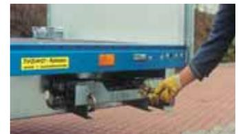
Die Halterungen und Sicherungen können in Halterungen unter der Ladebrücke verstaut werden.
