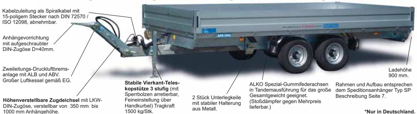
Kabelzuleitung als Spiralkabel mit 15-poligem Stecker nach DIN 72570 / ISO 12098, abnehmbar.
