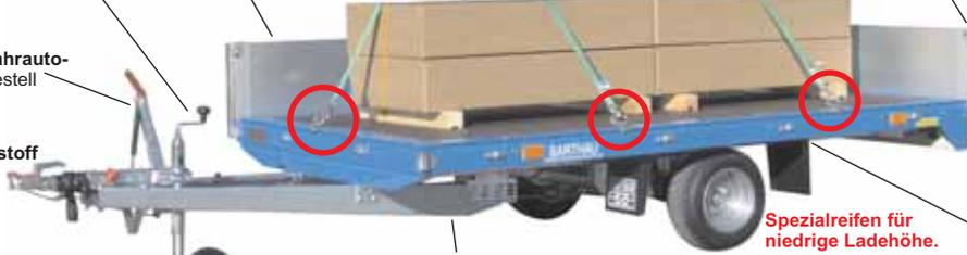
**Bodenfläche** aus belastbarer, witterungsbeständiger und rutschhemmender **Multiplex-Siebdruckplatte**. Verstärkt durch mehrere Querunterzüge.
