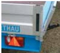
Der Anhänger hat vier steckbare Eckungen mit versenkten Verschlüssen. Jede Klappe hat zwei Verschlüsse, die in der Eckung gesichert werden. Das Dachgestell wird in die Eckungen eingesteckt.
