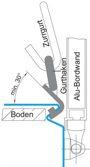
Bei Typ TK sind beide Längsprofile, die den Boden einfassen, als Zurrprofil ausgebildet. Bei Typ ET/EH, RT/RH und SP/TP ist der Boden rundum als Zurrprofil gekantet. Dieses Zurrprofil ist mit Bohrungen versehen und es können alle 10cm Gurthaken eingehakt werden. Die Gurthaken sind mit Magneten versehen und werden an der passenden Stelle fixiert. Mit unseren Gurthaken läßt sich die Ladung genau an der richtigen Stelle befestigen. Mit dem Schließen der Bordwand ist der Gurthaken gesichert.
